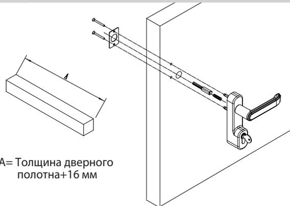
A = Толщина дверного полотна + 16 мм
